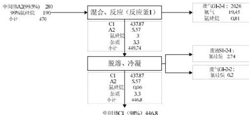
图 2-5 C1 制备工艺流程及产污环节 (kg/b)
